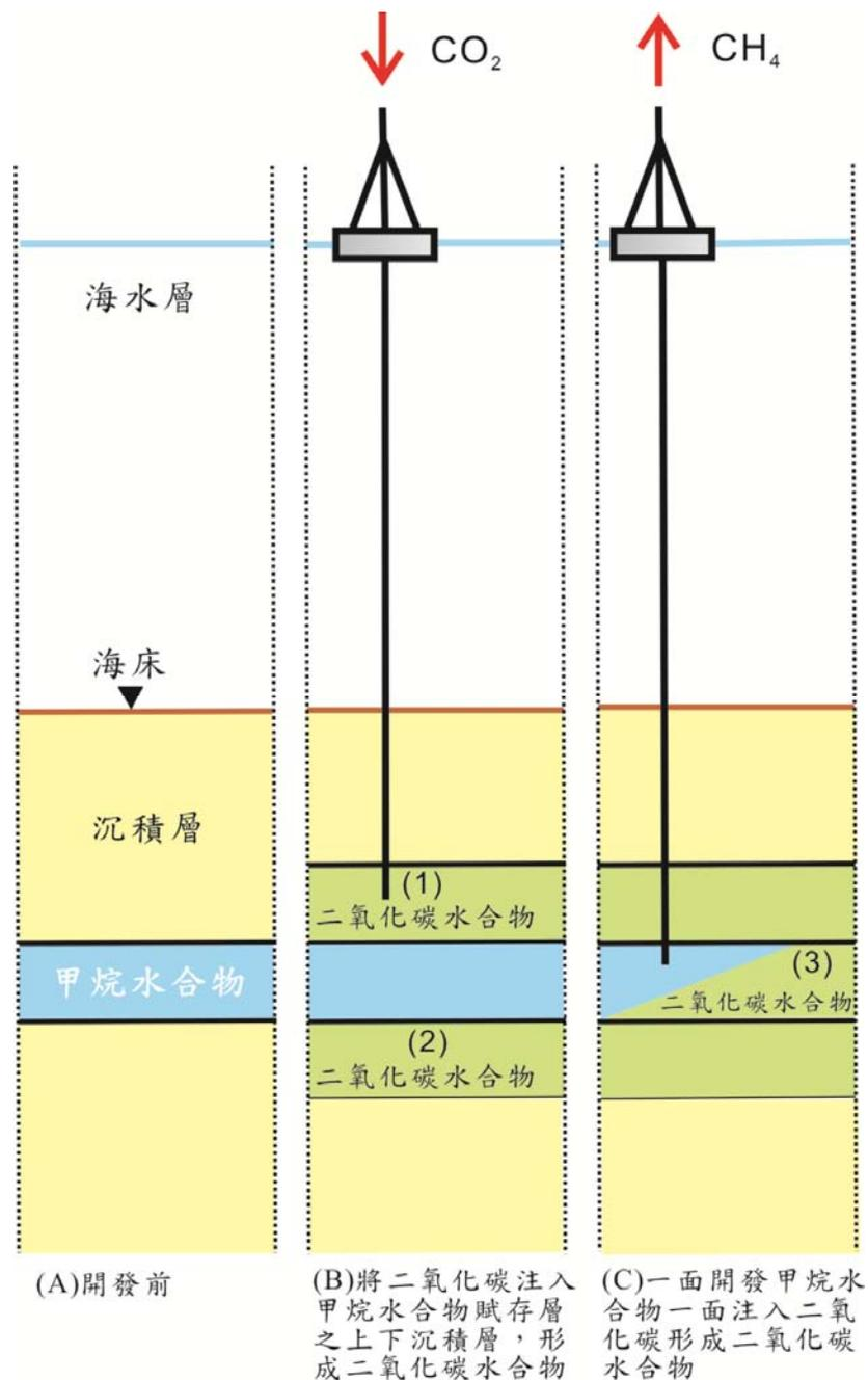
以二氧化碳封存置換甲烷氣示意圖(Ikegawa et al., 2007)
